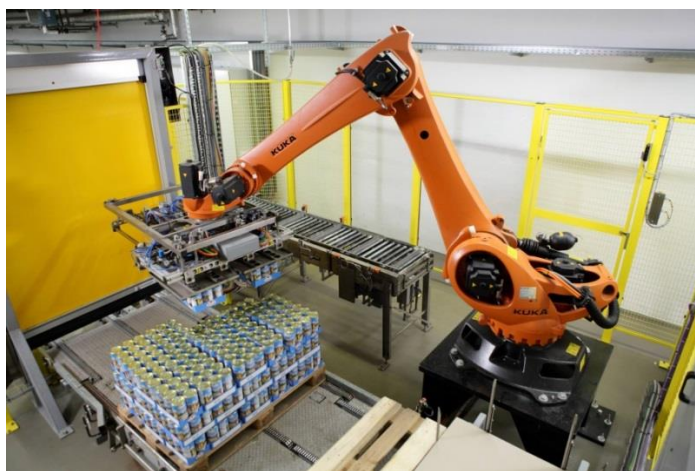
Рисунок 6 – Автоматизированный комплекс упаковывания робот KUKA KR 360 R3075 KR C4
