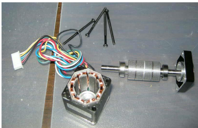
Рисунок 2 – Типовая конструкция гибридного шагового двигателя
