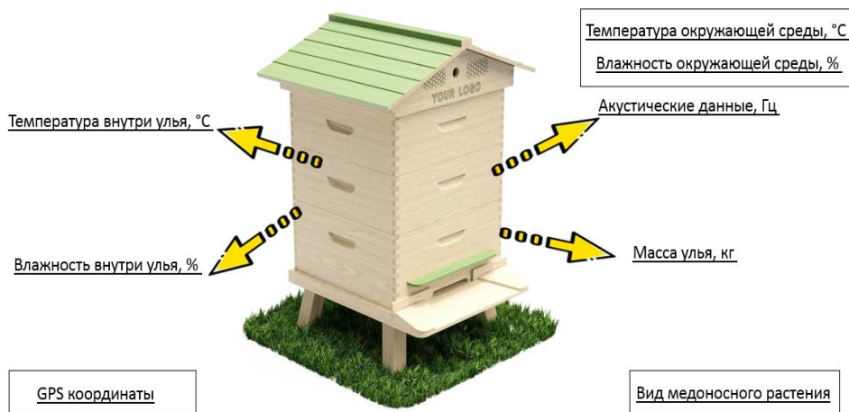
Рисунок 1 – Данные получаемые от датчиков в улье и пасеки
